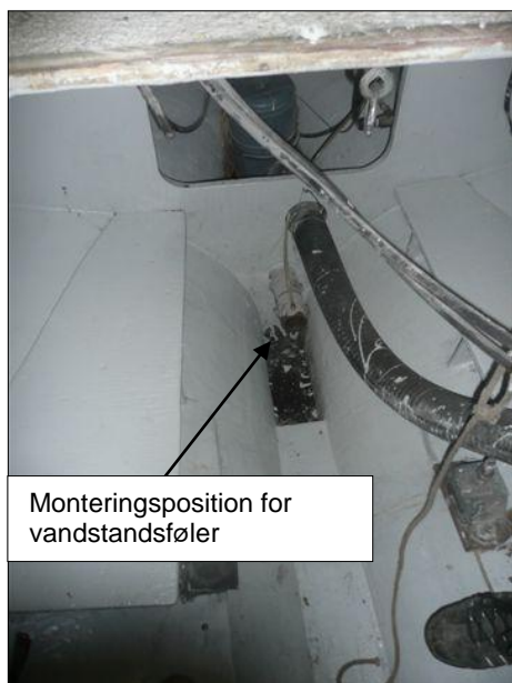
Figur 4: Monteringssted for vandstandsføler samt vandstandsføler Kilde: Den Maritime Havarikommission
