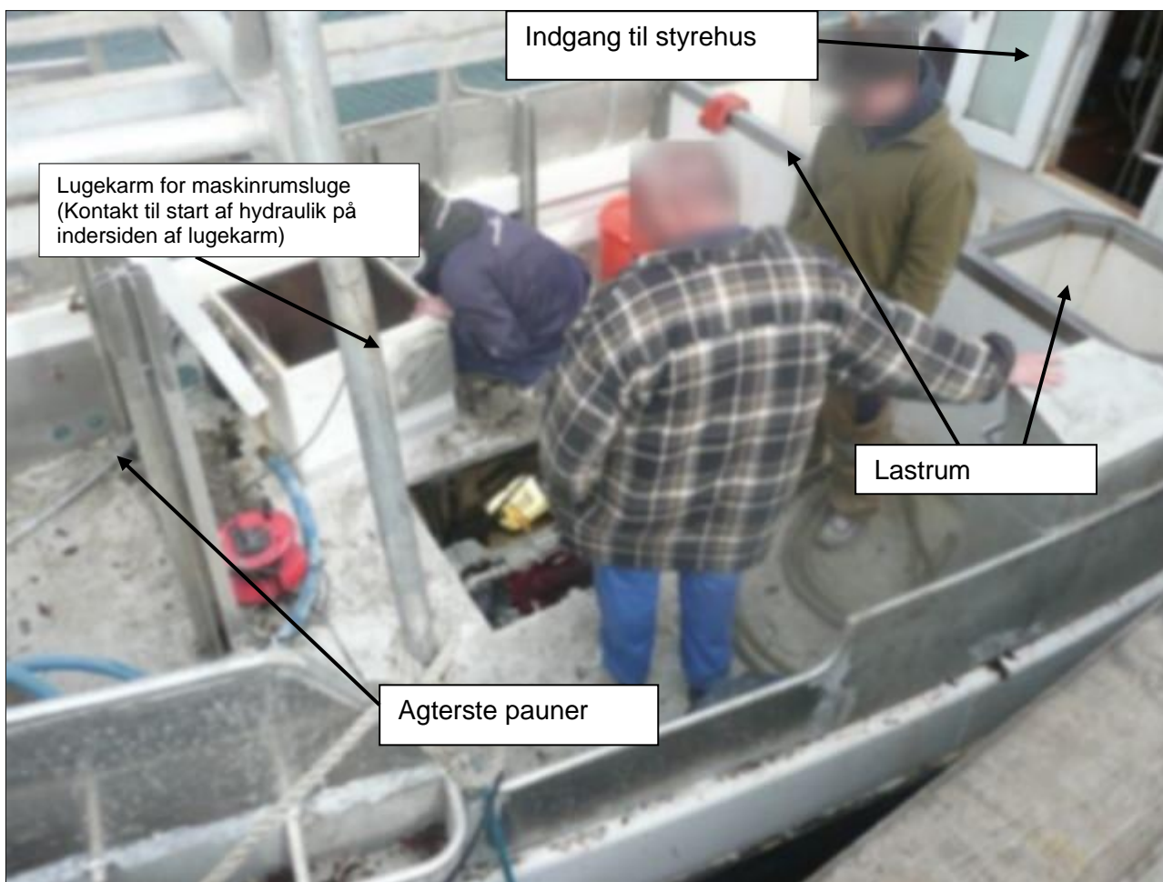
Figur 3: Detaljer fra dæksarrangementet Kilde: Den Maritime Havarikommission
