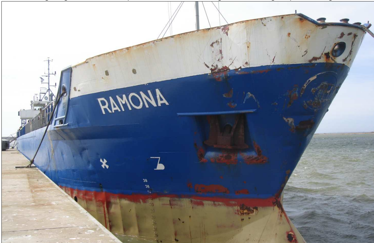
Figur 11: Skader på RAMONA efter kollision med Jernbanebroen Kilde: Den Maritime Havarikommission
