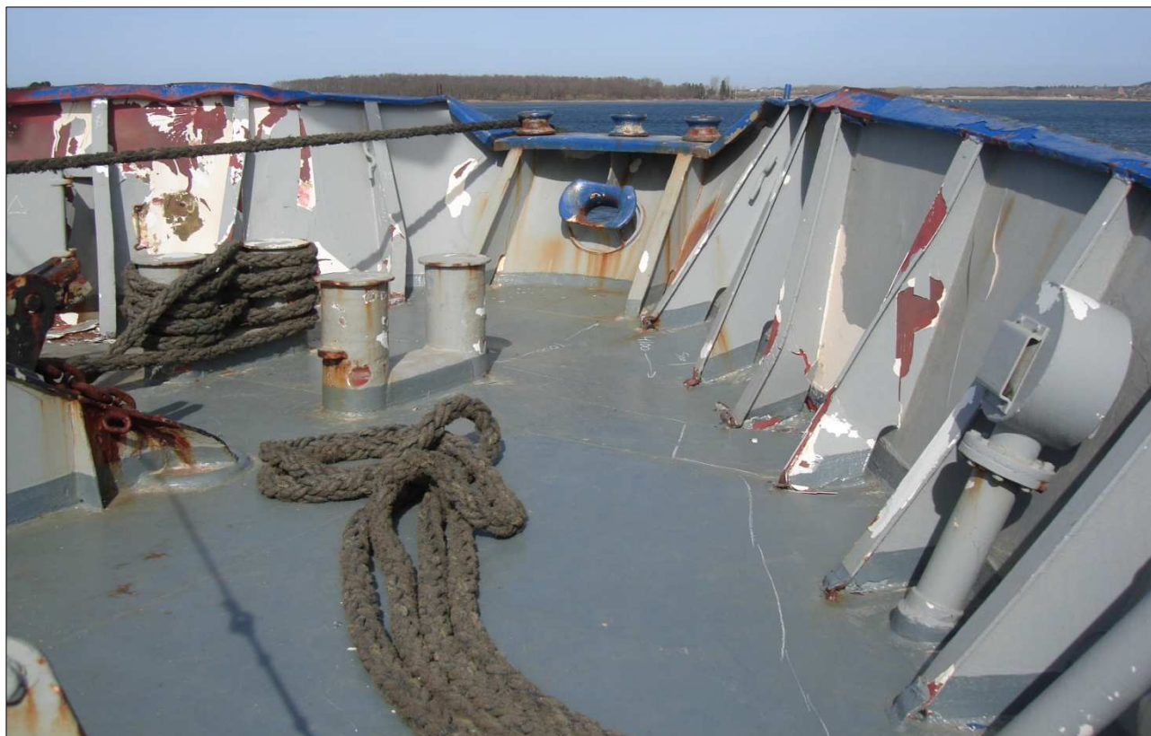
Figur 12: Skader på RAMONA efter kollision med Jernbanebroen Kilde: Den Maritime Havarikommission
