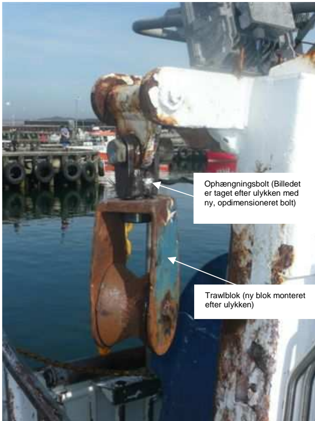
Figur 4: Trawlblok og ophængningsbolt Kilde: Den Maritime Havarikommission
