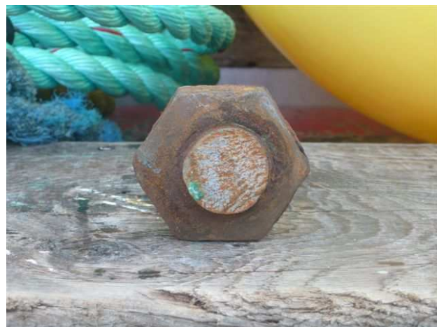
Figur 6: Hovedet som var den eneste bevarede del af ophængningsbolten. Kilde: Den Maritime Havarikommission
