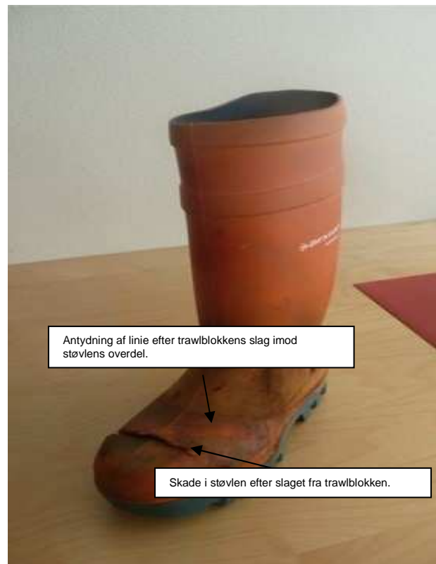
Figur 9: Skaden efter slaget fra trawlblokken på bagkant af støvlens sikkerhedsskappe. Kilde: Den Maritime Havarikommission
