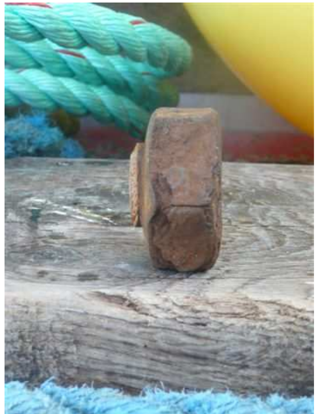
Figur 5: Hovedet som var den eneste bevarede del af ophængningsbolten. Kilde: Den Maritime Havarikommission
