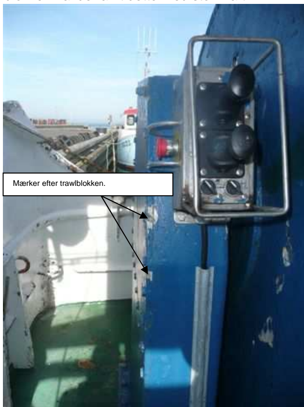
Figur 7: Mærker i trawlspletet efter blokken. Kilde: Den Maritime Havarikommission
