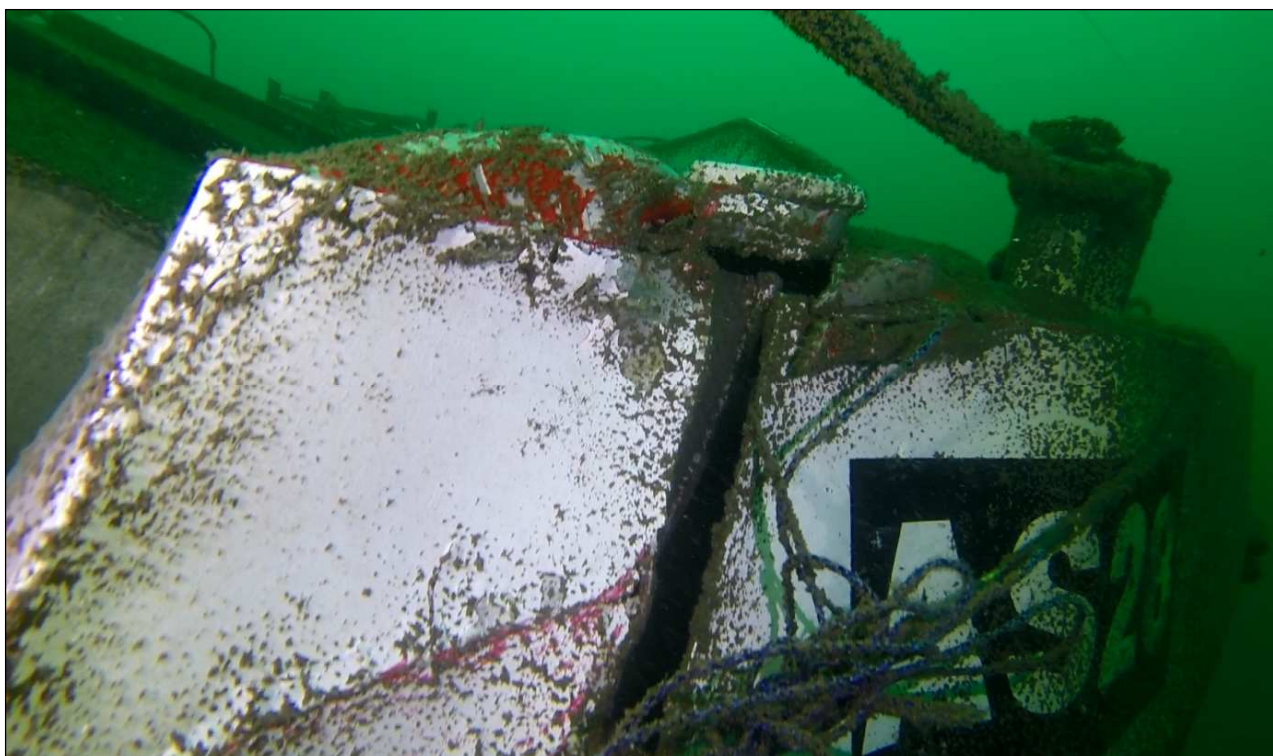
Figur 4: Skrogskade på ORION Kilde: Den Maritime Havarikommission
