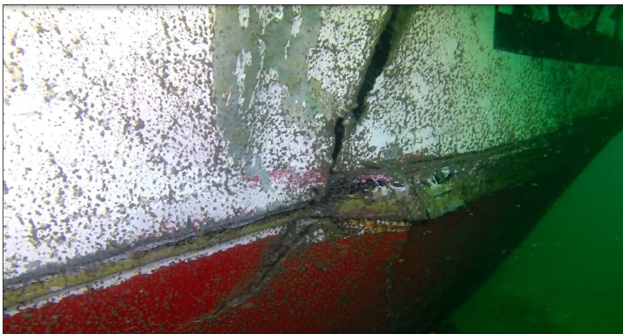
Figur 6: Skrogskade på ORION
