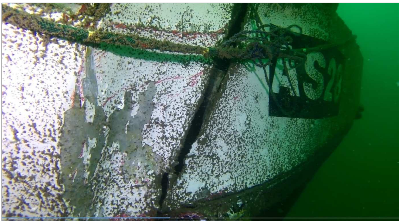
Figur 5: Skrogskade på ORION Kilde: Den Maritime Havarikommission
