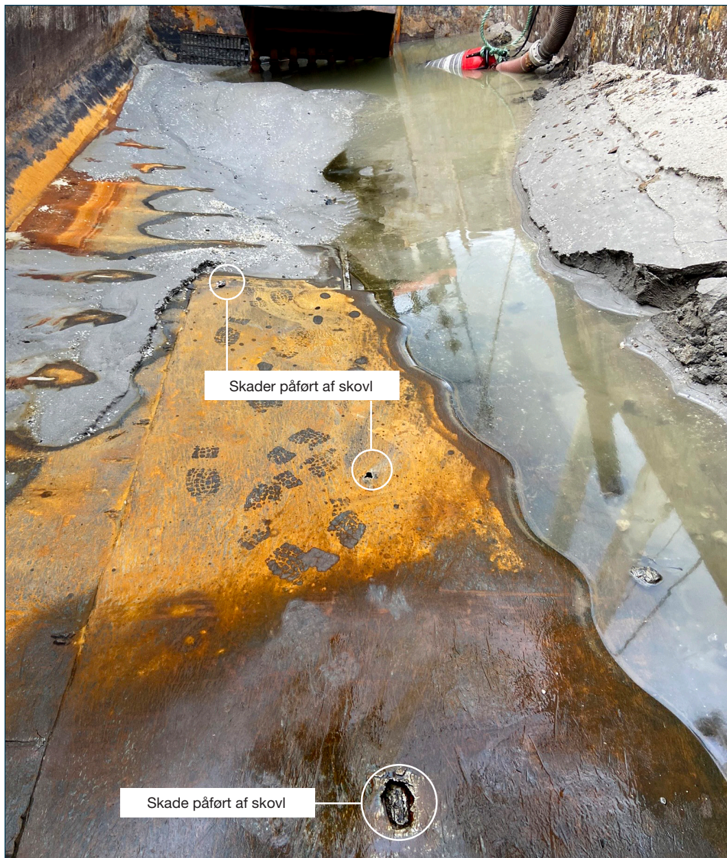
Figur 11: Skader på lastkasse som følge af arbejde med skovl. Kilde: Survey Association
