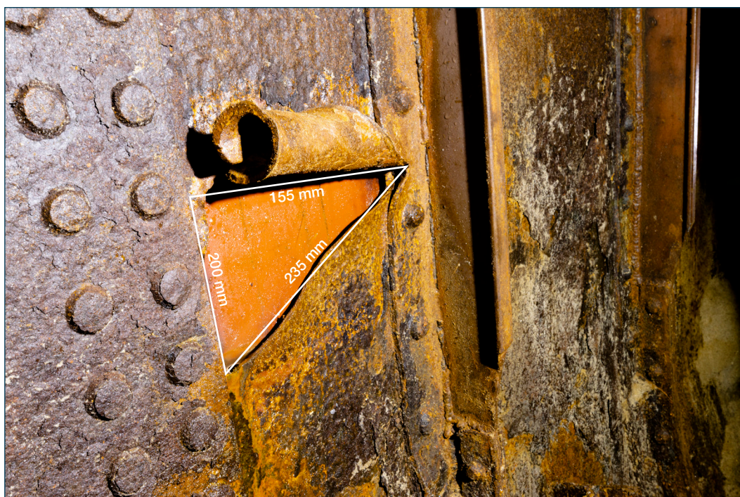
Figur 16: Skrogskadens dimensioner og karakter set inde fra. Kilde: DMAIB
